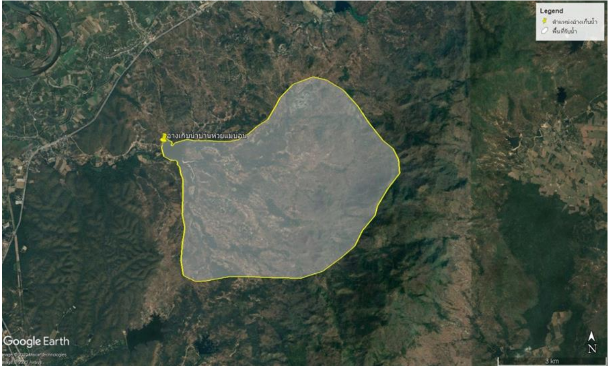
รูปที่ 5.22-3 พื้นที่รับน้ำของอ่างเก็บน้ำบ้านห้วยแม่บอน
