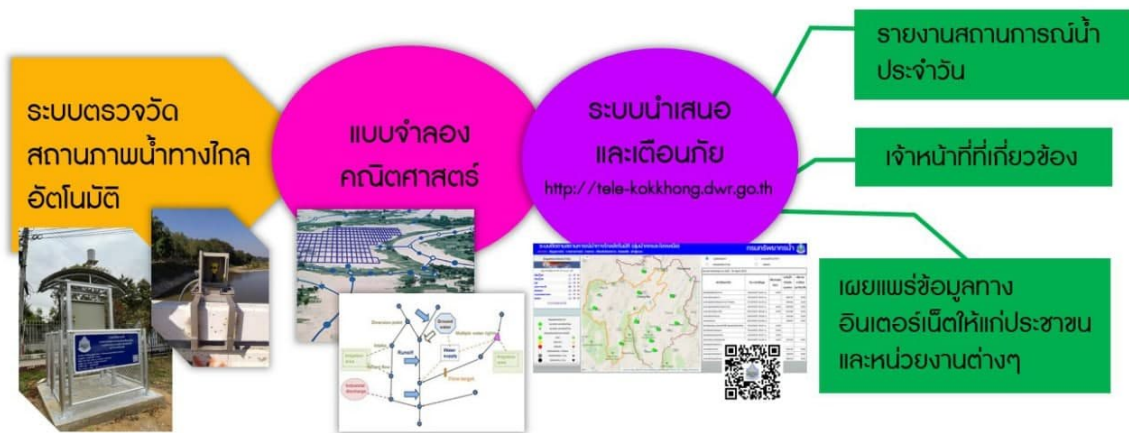
รูป 6 ระบบติดตามสถานการณ์น้ำทางไกลอัตโนมัติหรือระบบโทรมาตร
