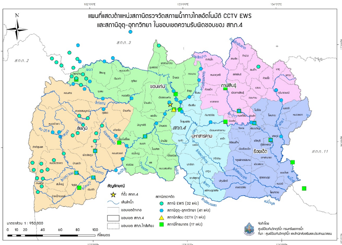
รูปที่ 4 ตำแหน่งสถานีตรวจวัดสภาพน้ำทางไกลอัตโนมัติ CCTV EWS และสถานีอุทก-อุทกวิทยา ในเขตพื้นที่ความรับผิดชอบของสำนักงานทรัพยากรน้ำภาค 4
