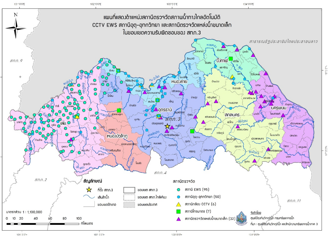
รูปที่ 4 ตำแหน่งสถานีตรวจวัดสภาพน้ำทางไกลอัตโนมัติ CCTV EWS สถานีอุตุ-อุทกวิทยา และสถานีตรวจวัดแหล่งน้ำขนาดเล็ก ในเขตพื้นที่ความรับผิดชอบของสำนักงานทรัพยากรน้ำภาค 3
