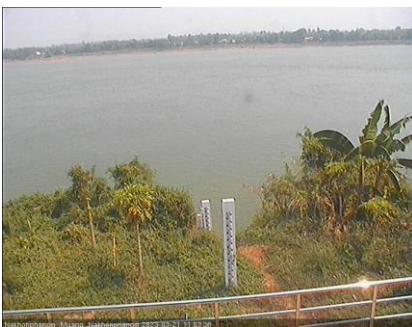
สถานีวัดระดับน้ำอัตรโนมัต - อ.เมือง จ.นครพนม (ลุ่มน้ำโขงตะวันออกเฉียงเหนือ)
