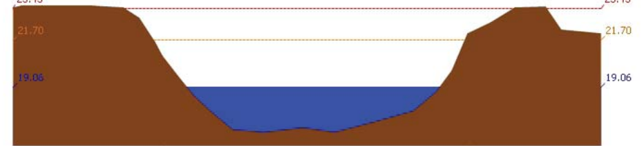
สถานี 110504T แม่น้ำตากแดดที่บ้านบุญลือ ต.เนินแจง อ.เมืองอุทัยธานี จ.อุทัยธานี ระดับน้ำ 19.06 ม.รทก.
