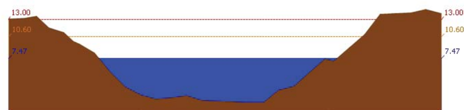
สถานี 120106T แม่น้ำป่าสักที่ อ.เสาใต้ ต.ศาลาไทย อ.เสาใต้ จ.สระบุรี ระดับน้ำ 7.47 ม.รทก.
