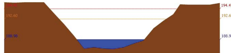
สถานี 120901T หัวขยวมกเหล็กที่ อ.มวกเหล็ก ต.มวกเหล็ก อ.มวกเหล็ก จ.สระบุรี ระดับน้ำ 188.98 ม.รทก.
