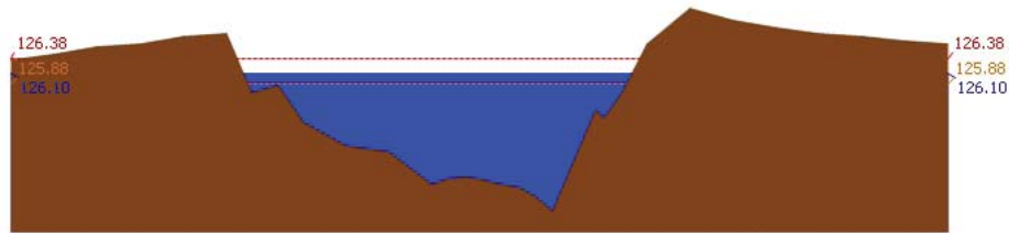
สถานี 110301T คลองโพธิ์ที่บ้านคลองบ่วงสามัคคี ต.ปางสวรรค์ อ.ชุมตาบง จ.นครสวรรค์ ระดับน้ำ 126.10 ม.รทก.
