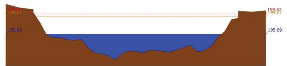
สถานี 070115T น้ำแม่วังที่บ้านอ้อ ต.แม่กัวะ อ.สบปราบ จ.ลำปาง ระดับน้ำ 195.89 ม.รทก.
