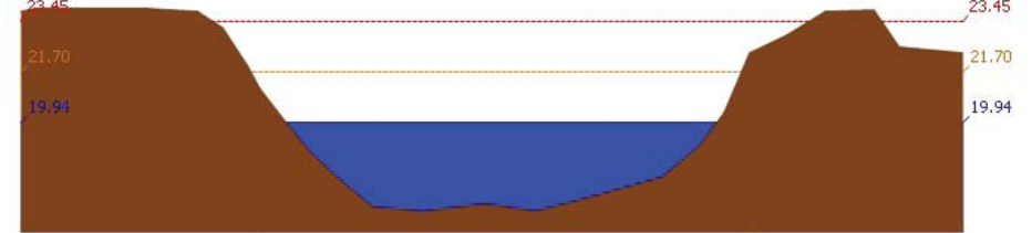
สถานี 110504T แม่น้ำตากแดดที่บ้านบุญลือ ต.เนินแจง อ.เมืองอุทัยธานี จ.อุทัยธานี ระดับน้ำ 19.94 ม.รทก.
