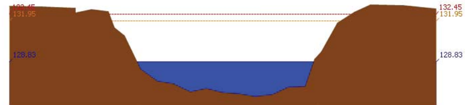
สถานี 070118T แม่น้ำวังที่บ้านแม่สลิค ต.แม่สลิค อ.บ้านตาก จ.ตาก ระดับน้ำ 128.83 ม.รทก.
