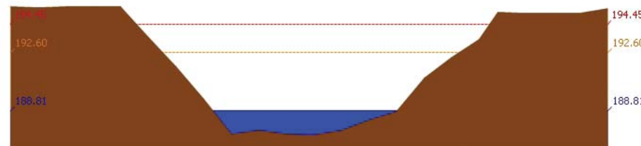
สถานี 120901T หัวขยมวกเหล็กที่ อ.มวกเหล็ก ต.มวกเหล็ก อ.มวกเหล็ก จ.สระบุรี ระดับน้ำ 188.81 ม.รทก.
