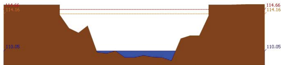
สถานี 061801T คลองวังเจ้าที่บ้านคลองลึก ต.เชียงทอง อ.วังเจ้า จ.ตาก ระดับน้ำ 110.05 ม.รทก.
