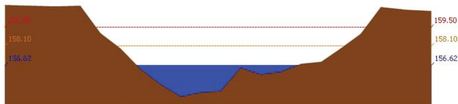
สถานี 120305T หัวขบวนที่ อ.หล่มเก่า จ.พิษณุโลก ระดับน้ำ 156.62 ม.รทก.
