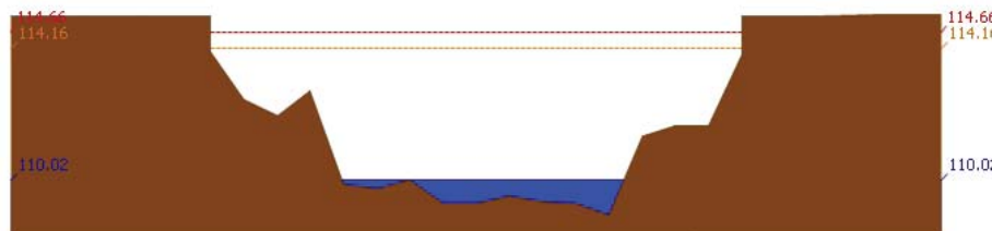
สถานี 061801T คลองวังเจ้าที่บ้านคลองลึก ต.เชียงทอง อ.วังเจ้า จ.ตาก ระดับน้ำ 110.02 ม.รทก.
