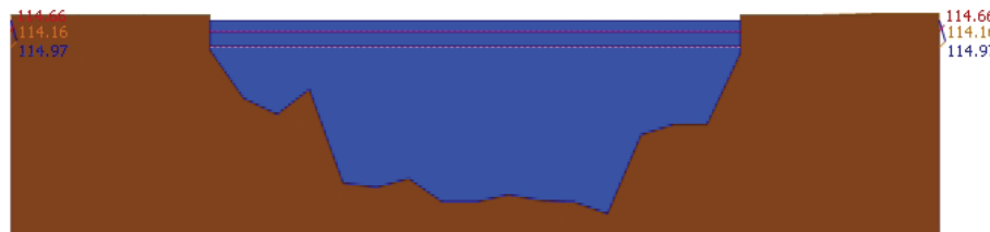
สถานี 061801T คลองวังเจ้าที่บ้านคลองลึก ต.เชียงทอง อ.วังเจ้า จ.ตาก ระดับน้ำ 114.97 ม.รทก.
