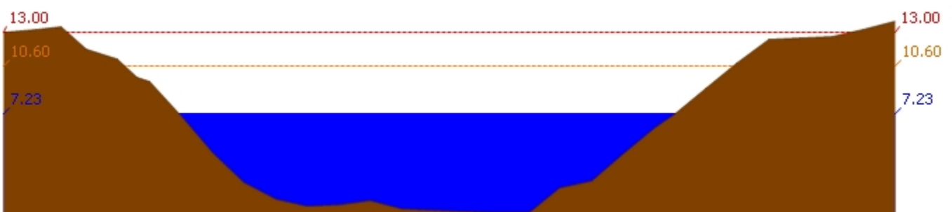
สถานี 120106T แม่น้ำป่าสักที่ อ.เสนาห์ ต.ศาลาวิไทย อ.เสนาห์ จ.สระบุรี ระดับน้ำ 7.23 ม.รทก.
