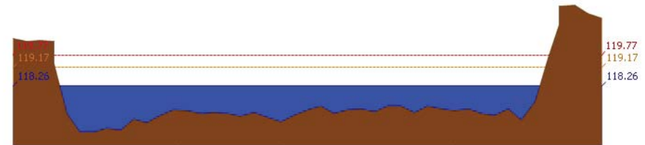
สถานี 060111T แม่น้ำปิงที่บ้านปากร่องห้วยจี่ ต.ตากออก อ.บ้านตาก จ.ตาก ระดับน้ำ 118.26 ม.รทก.
