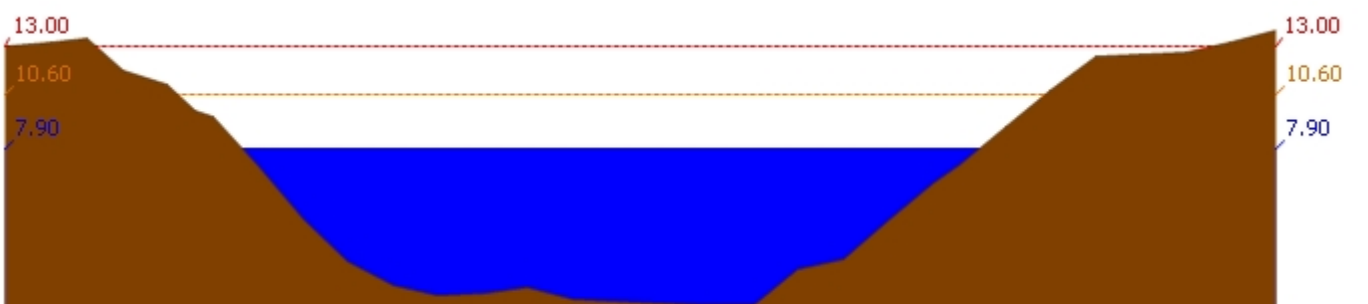
สถานี 120106T แม่น้ำป่าสักที่ อ.เสาไห้ ต.ศาลาวิไทย อ.เสาไห้ จ.สระบุรี ระดับน้ำ 7.90 ม.รทก.
