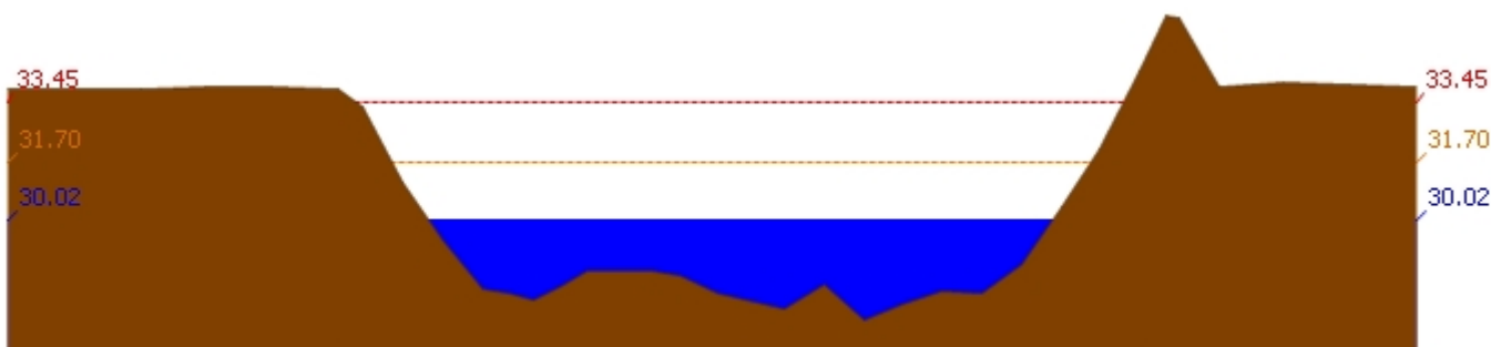
สถานี 110503T แม่น้ำตากแดดที่บ้านหนองขาลาย ต.หนองหลวง อ.สว่างอารมณ์ จ.อุทัยธานี ระดับน้ำ 30.02 ม.รทก.
