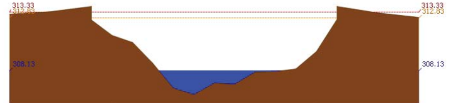
สถานี 060814T น้ำแม่ขานที่บ้านท่าโป่ง ต.บ้านแม่ อ.สันป่าตอง จ.เชียงใหม่ ระดับน้ำ 308.13 ม.รทก.
