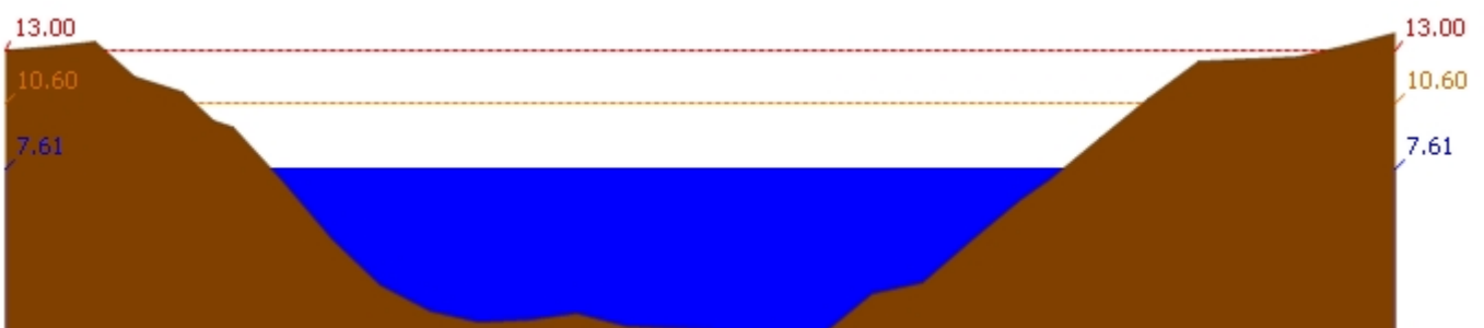
สถานี 120106T แม่น้ำป่าสักที่ อ.เสนาห์ ต.ศาลาวิไทย อ.เสนาห์ จ.สระบุรี ระดับน้ำ 7.61 ม.รทก.
