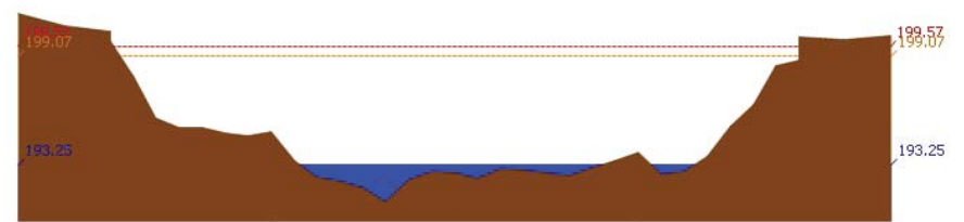
สถานี 070115T น้ำแม่วังที่บ้านอ้อ ต.แม่กัวะ อ.สบปราบ จ.ลำปาง ระดับน้ำ 193.25 ม.รทก.
