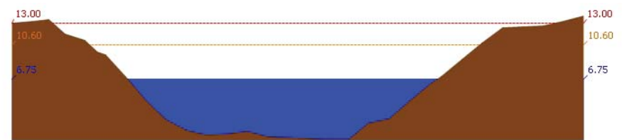
สถานี 120106T แม่น้ำป่าสักที่ อ.เสนาใต้ ต.ศาลาไทย อ.เสนาใต้ จ.สระบุรี ระดับน้ำ 6.75 ม.รทก.
