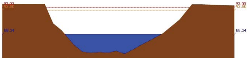
สถานี 120110T แม่น้ำป่าสักที่บ้านวังโสด ต.วังโสด อ.หนองไผ่ จ.เพชรบูรณ์ ระดับน้ำ 88.34 ม.รทก.
