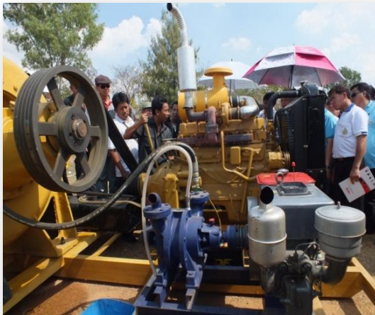
เครื่องสูบน้ำ ขนาด ๒๖ นิ้ว อัตราการสูบ ๐.๙๒ ลบ.ม/วินาที
