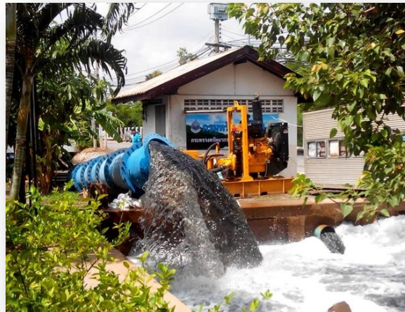
เครื่องสูบน้ำ ขนาด ๑๒ นิ้ว อัตราการสูบ ๐.๔๕ ลบ.ม/วินาที
