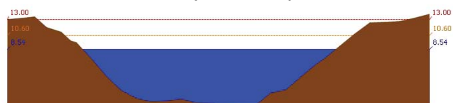
สถานี 120106T แม่น้ำป่าสักที่ อ.เสาไห้ ต.ศาลาวิไทย อ.เสาไห้ จ.สระบุรี ระดับน้ำ 8.54 ม.รทก.
