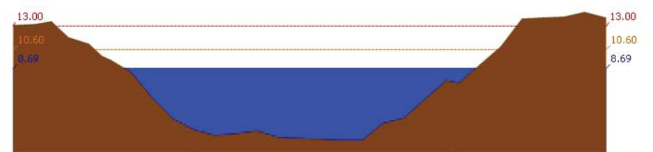
สถานี 120106T แม่น้ำป่าสักที่ อ.เสาไห้ ต.ศาลาพิไทย อ.เสาไห้ จ.สระบุรี ระดับน้ำ 8.69 ม.รทก.
